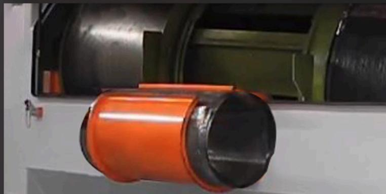
Le changement des tamis peut être effectué rapidement à partir des portes latérales. Tous les tamis et tambours, sont auto-nettoyants. Un échantillon peut être recueilli à partir des points de contrôle au cours du traitement.
